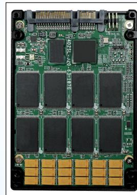
dert werden. Sobald ein Stromausfall registriert wird, aktiviert die Firmware des Laufwerks eine spezielle Power-Down-Sequenz, die alle Daten aus dem DRAM-Puffer auf den Flashspeicher kopiert. Während dieser Sequenz bezieht das Laufwerk den Strom über die verbauten Kondensatoren. Somit können Daten sicher und effektiv geschützt werden.
